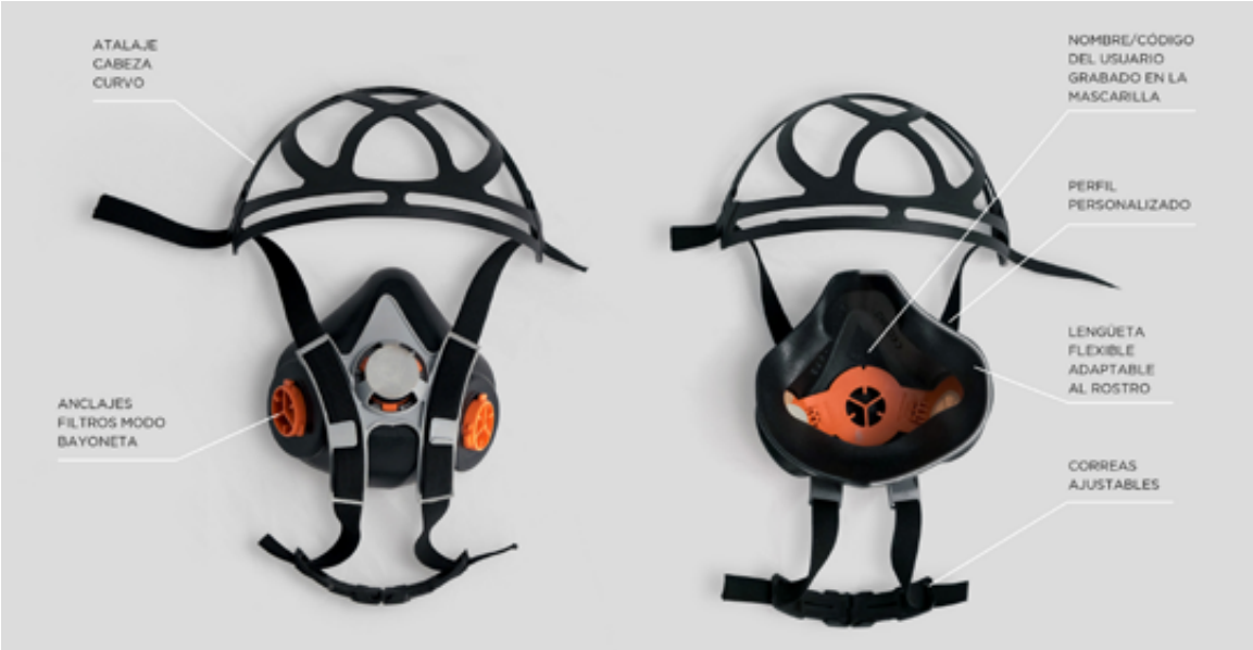
Adquisición de una nueva máscara buconasal diseñada individualmente para cada trabajador. Adaptándose al rostro de cada persona gracias a un sistema basado en el reconocimiento facial e impresión en 3D.
